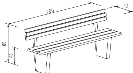
Bank v / Runge mit Sitz- und Rückenbelag aus witterungsbeständigem Hartholz Niangon, dunkelbraun lasiert. 3 Sitzleisten (12 x 3,5 cm) und 3 Rückenleisten (5,9 x 3,5 cm). Rückenholm aus feuerverzinktem Stahlrohr 60/40 mm. Füße 8 cm breit, aus zementgrauem Beton in Form eines abgeschnittenen "V" zum Fundamentieren. L 200. Gewicht 125 kg.
