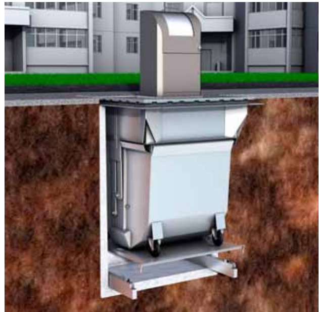
EUROPAbio består af en nedgravet betonkasse som yderbeholder og en indebeholder i galvaniseret stål. Inderbeholderen er udviklet til bioaffald med øje for høj hygiejne og reducerede lugtgener.
