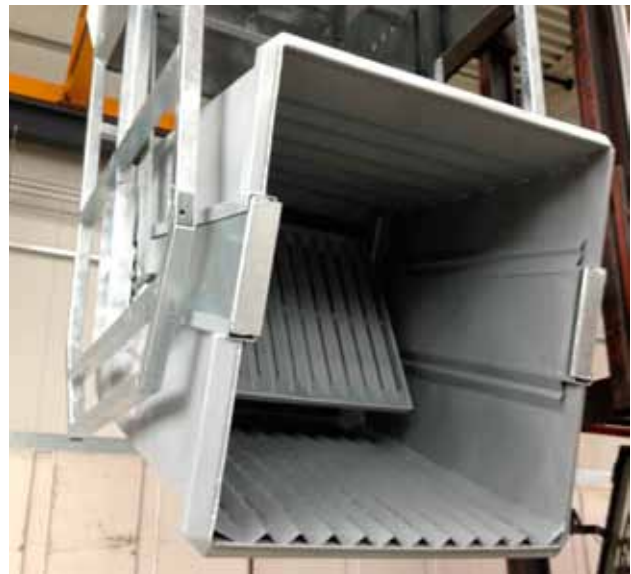
Indersiden på den inderste container er konstrueret med luftkanaler, som både gør tømningen lettere og leder væsken fra bioaffaldet ned i den helt tætte væskebeholder/perkolatbeholder.
